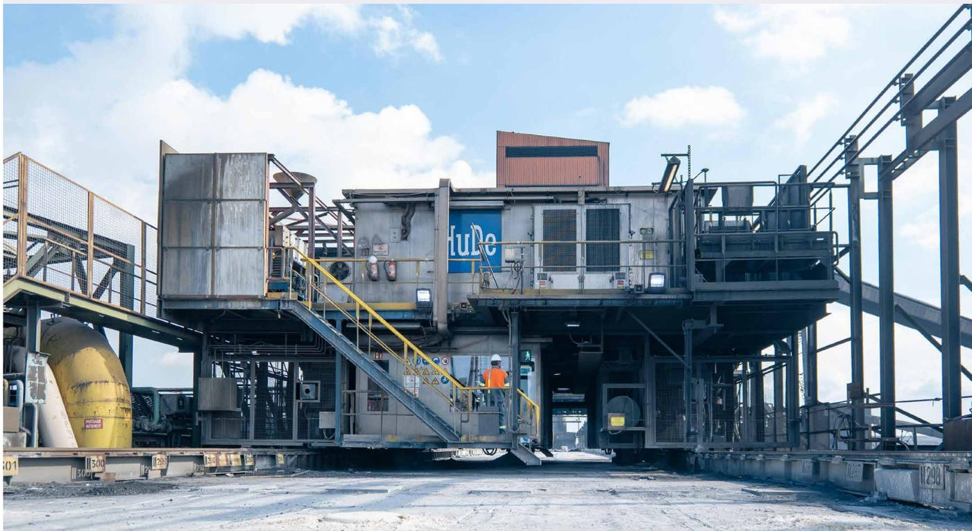
**C'est une innovation développée à Fos. Sur le toit des fours de la cokerie, l'enfourneuse s'arrête automatiquement dès que la présence d'un piéton mal positionné est détectée par un système faisant appel à l'intelligence artificielle. Une adaptation du système « Blaxtair » unique en son genre.**
