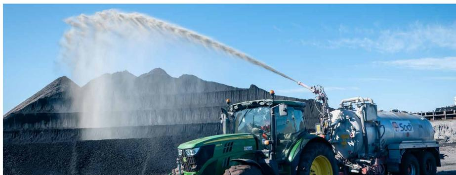
recouvrir efficacement. Ce produit visible forme une croûte sur les tas lors de sa mise en place, et peut résister à des vents approchant les 100 km/h. Sur les poussières diffuses
